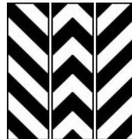
2.2 - обозначает нижний край пролетного строения тоннелей, мостов и путепроводов;
