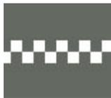
1.26 (цвет - желтый) - обозначает участок перекрестка, на который запрещается выезжать, если впереди по пути следования образовался затор, который вынудит водителя остановиться, создав препятствие для движения транспортных средств в поперечном направлении, за исключением поворота направо или налево в случаях, установленных настоящими Правилами. Разметка может применяться самостоятельно либо совместно с дорожным знаком 1.35.
