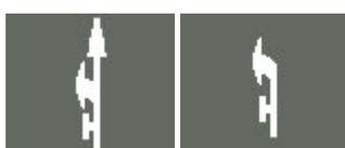
**1.19** - предупреждает о приближении к сужению проезжей части (участку, где уменьшается число полос движения в данном направлении) или к линиям разметки 1.1 или 1.11, разделяющим транспортные потоки противоположных направлений;
